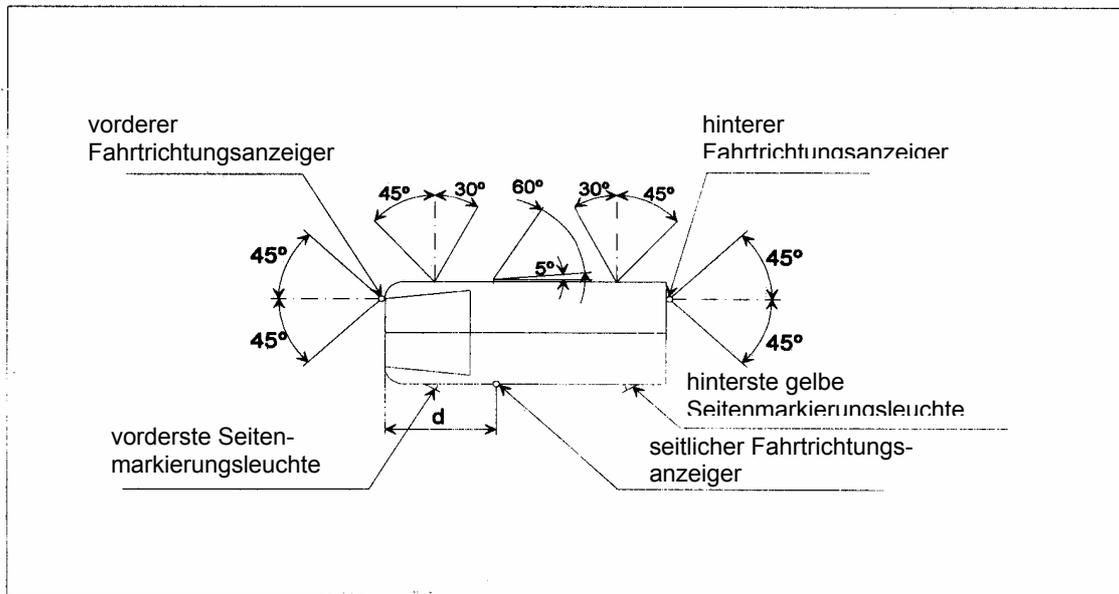
Vertikalwinkel:  $15^\circ$  über und unter der Horizontalen. Der Vertikalwinkel unter der Horizontalen darf auf  $5^\circ$  verringert sein, wenn die Anbauhöhe der Leuchten kleiner als 750 mm ist.
